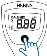
Appuyer sur ON/OFF pour allumer l'instrument.
