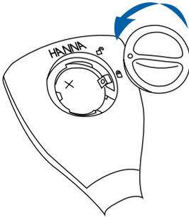
Pour remplacer la pile Li-ion CR2032, tourner le couvercle du compartiment à pile, à l'arrière de l'instrument, dans le sens anti-horaire pour le débloquer. Retirer le couvercle et remplacer la pile, polarité + vers le dessus.
