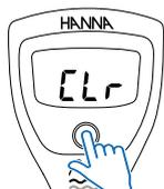
Mettre l'instrument en mode étalonnage. Appuyer et maintenir enfoncée la touche ON/OFF jusqu'à ce que "CLr" s'affiche. L'instrument est à présent sur l'étalonnage d'usine. Aucun symbole ne sera affiché en mode lecture tant qu'un nouvel étalonnage n'est pas réalisé.
