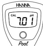
Lorsque "7.01" clignote, placer le bout de l'électrode dans une solution tampon pH 4,01; 7,01 ou 10,01.
