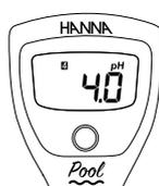
L'instrument revient en mode mesure et le symbole du point étalonné sera affiché.
