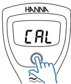
À partir du mode mesure, appuyer et maintenir enfoncée la touche ON/OFF jusqu'à l'affichage de "CAL".
