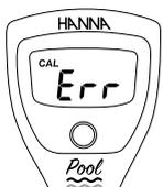
En mode étalonnage, si l'instrument affiche un message "Err" lorsque l'électrode est dans une solution étalon fraîche, alors l'électrode doit être nettoyée. Placer l'électrode dans la solution de nettoyage **HI7006014** pendant 15 minutes. Rincer à l'eau pure et mettre à tremper dans **HI7003004** pendant une heure avant d'étalonner. Si le message d'erreur "Err" persiste l'électrode **HI1271** doit être remplacée.
