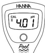
Utiliser pH 4,01 ou pH 10,01 pour réaliser un étalonnage en deux points. La valeur est automatiquement reconnue avec le sablier clignotant.
