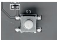
3. à chaque pression sur le bouton test, la polarité change. On peut ainsi visualiser la puissance fournie par la cellule sur les deux polarités.
