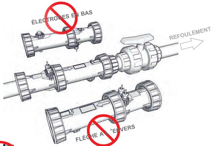
La cellule d'électrolyse a un sens de fonctionnement. L'eau doit toujours la traverser dans le sens indiqué par la flèche.
