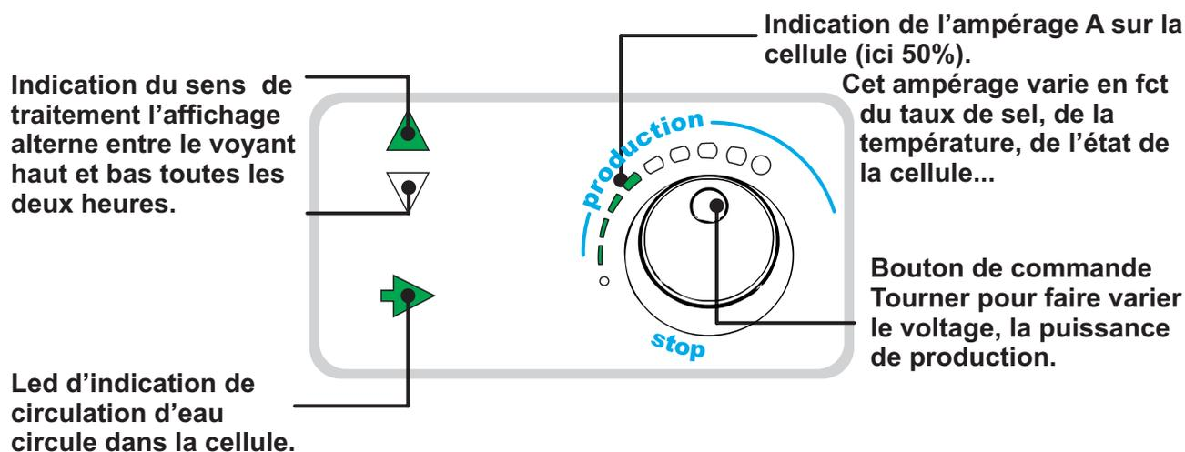
Au démarrage régler l'appareil à mi-puissance, tourner le bouton pour avoir 4 leds allumées. Après quelques jours d'utilisation suivant l'état de l'eau (vérifier le niveau de chlore résiduel) augmenter ou diminuer légèrement la production avec le bouton de commande.
