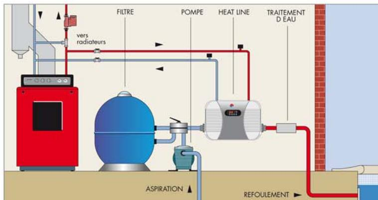
**ATTENTION** : Le piquage du circuit primaire doit être réalisé en amont de toute vanne ou pompe.
