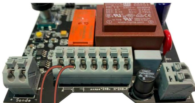
**Electrolyseur:** Câbler la sortie **RC** contact sec du Phredo SPE sur l'entrée volet roulant des électrolyseurs de Régul'.
